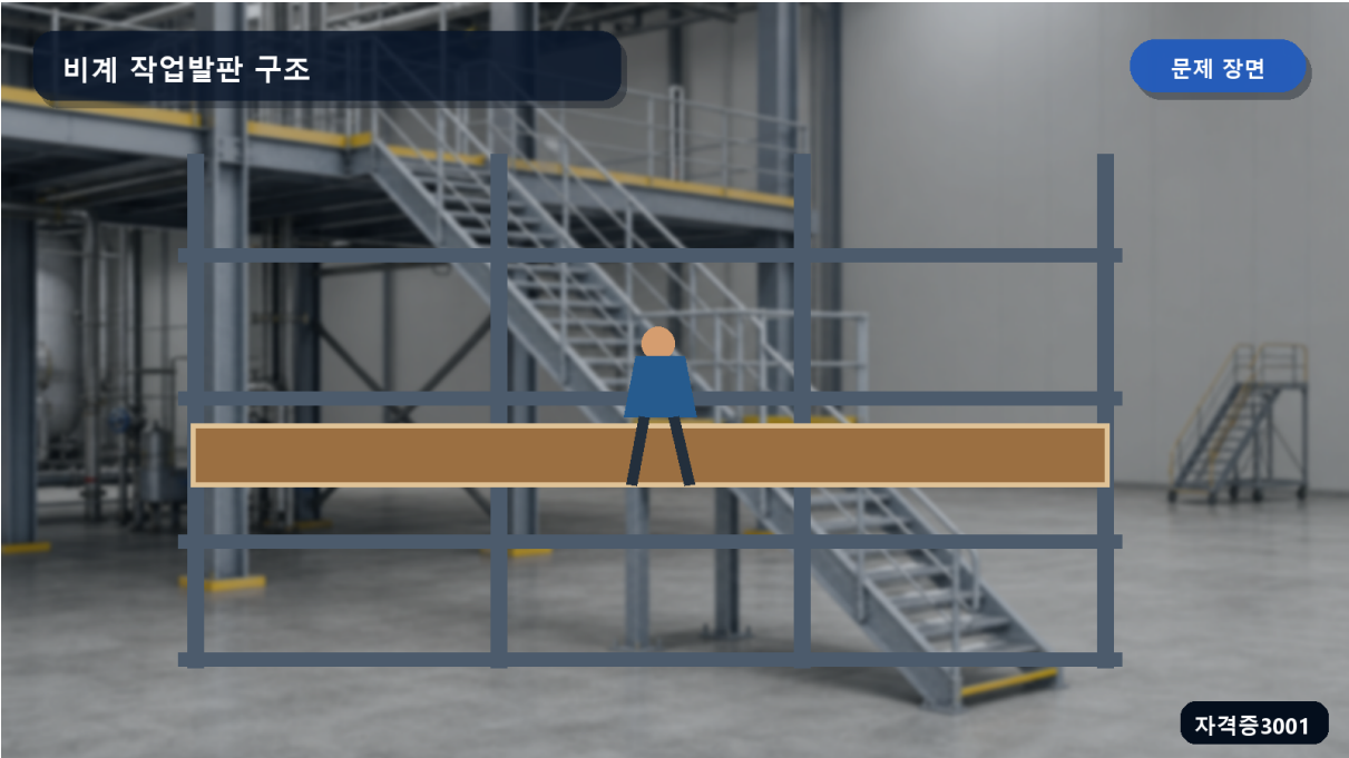
높이 2미터 이상 비계에 작업발판과 난간이 설치된 장면
