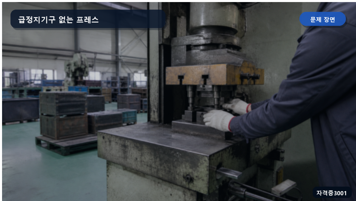
급정지기구가 없는 기계식 프레스의 금형 가까이 손을 둔 작업 장면
