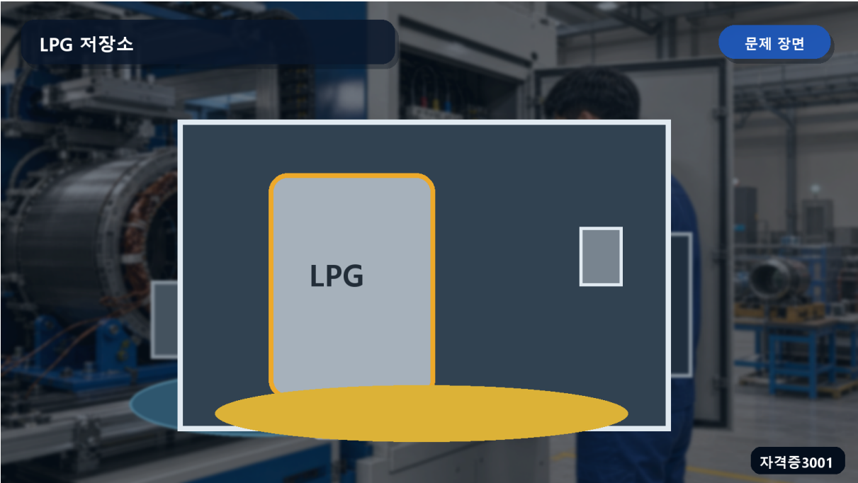
LPG 저장소 내부 바닥 부근에 가스가 체류하고 벽 전등 스위치가 있는 장면
